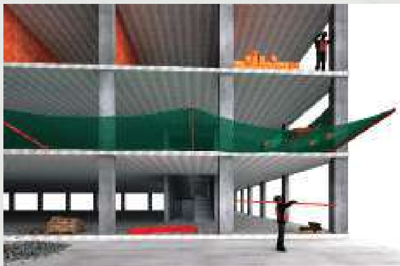
Moduł LiteMESH w konfiguracji mocowania górnego.
