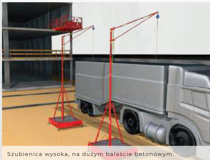
Szubienica mocowana na balaście betonowym.
